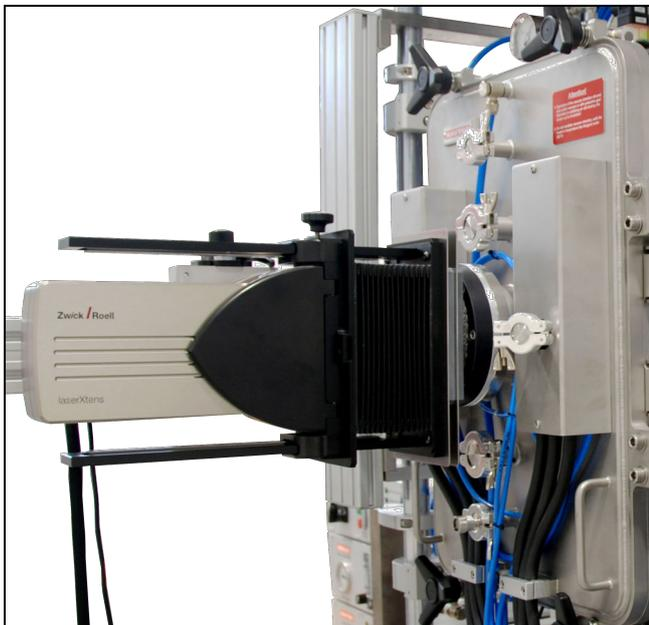
laserXtens 1-32 HP/TZ an Vakuumkammer
